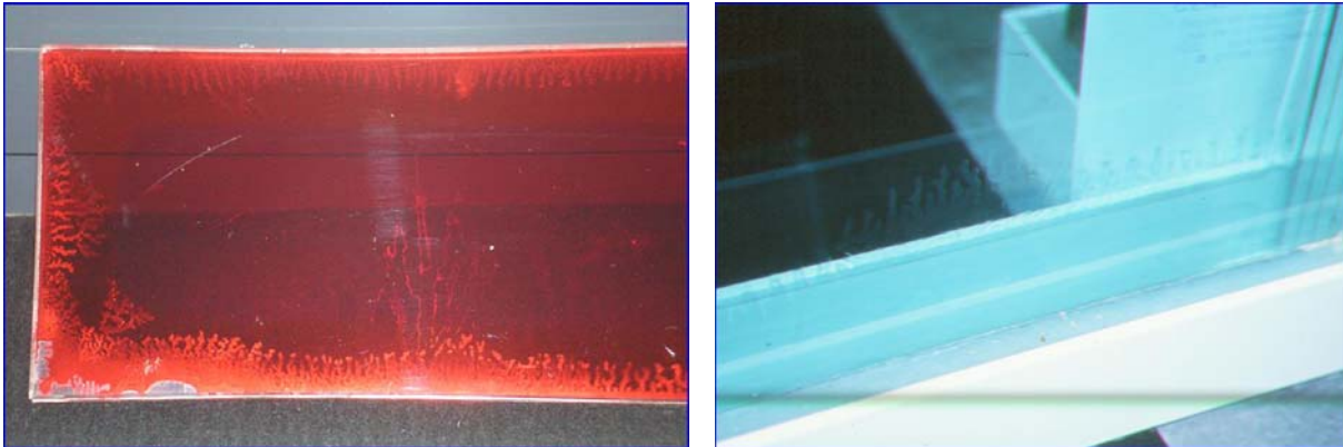
Figuur 10: Onthechting van een staal van gelaagd glas en in-situ onthechting als gevolg van contact tussen het gelaagd glas en siliconenzuur.
