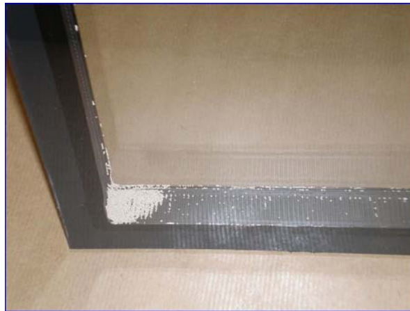
Figuur 15: Abnormale aanwezigheid van korrels droogmiddel in de spouw.
